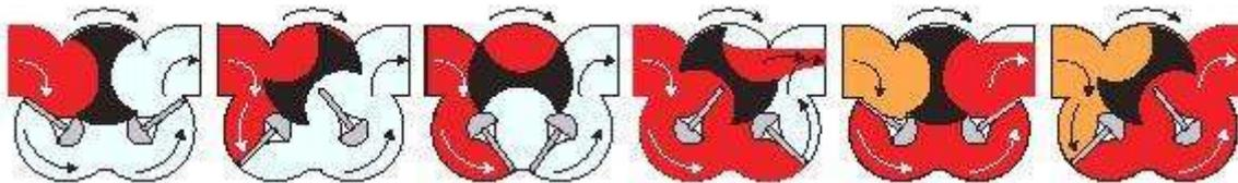
Отсутствие колебаний и возвратно-поступательных движений позволяет расходомерам иметь крайне жёсткие и постоянные допуски, что в свою очередь обеспечивает постоянство точности и длительный срок службы.
